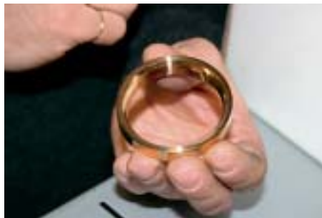
Wenn es um Höchstleistungen geht, kommen oft exotische Werkstoffe zum Einsatz. Im Bild berylliumfreie Ventil-sitzringe
