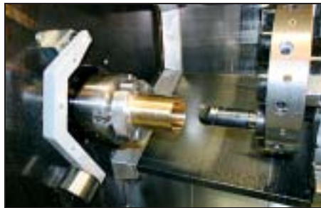
Ausdrehen einer Zylinderbuchse aus einer Kupfer-Aluminiumbronze
