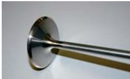
Die nächste harte Nuss wartet schon. Titan-Ventile müssen nach Kurpas ausdrehen überdreht werden
